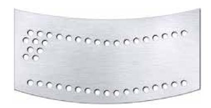
Durch die hohen Bearbeitungskräfte ändern sich die Abmessungen des Werkstückes geringfügig, d.h. auch das Lochfeld wird gedehnt.
